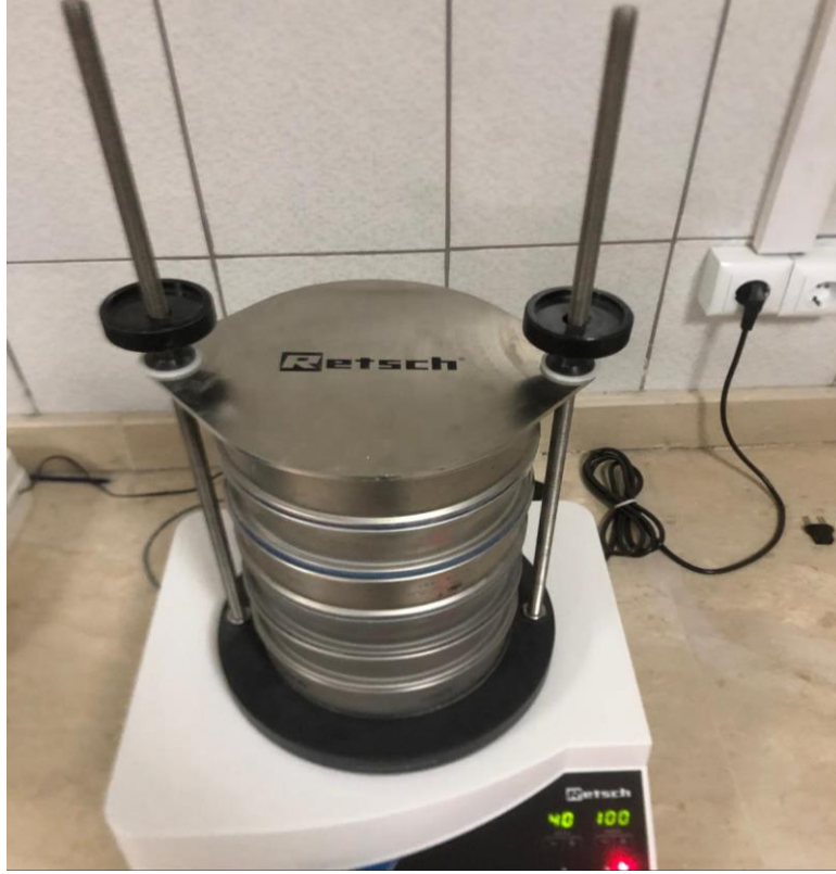
Şekil 3.2. AS200 BASiC Eleme cihazının kurulumu ve cihazın görünümü
